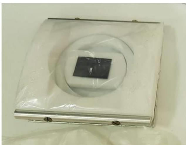
Рис. 2.3. Герметичная ячейка с помещенным внутрь нее образцом.
