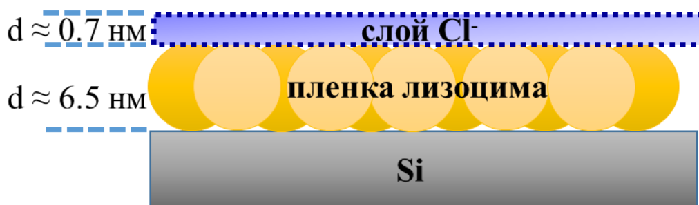
Рис. 3.8. Схема белковой пленки, сформированной из раствора лизоцима с осадителем NaCl, полученной модифицированным методом ЛШ, построенная на основе данных исследования СРВ в области ПВО.
