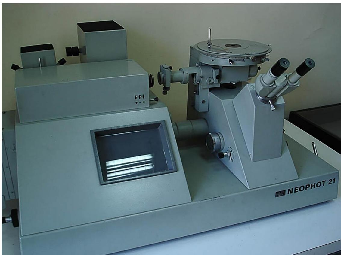
Рис. 25. Металлографический фотомикроскоп НЕОРНОТ-21.
