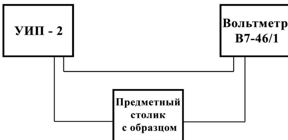
Рис. 19. Схема экспериментальной установки по снятию электрических характеристик, состоящая из универсального источника питания УИП – 2, программируемого вольтметра В7-46/1, а также предметного столика.
