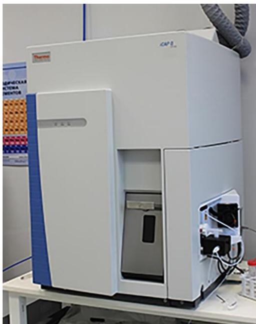
Рис. 18. Масс-спектрометр iCAP-Q с индуктивно-связанной плазмой
