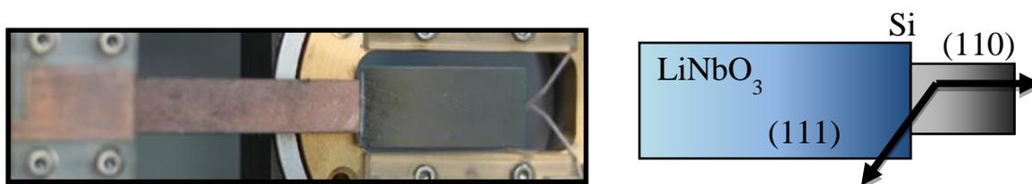
*Рис. 42. Фотография используемого адаптивного элемента, а также его схематичное изображение.*
