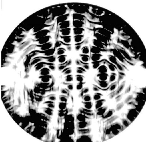
*Рис. 10. Топограмма кристаллического кварцевого резонатора, в котором возбуждены ультразвуковые колебания с амплитудой  $80 \text{ мкА/мм}^2$ . Хорошо заметны ангармонические деформации.*
