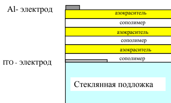
Рис. 5 Пример структуры экспериментального образца из 3 пар чередующихся слоёв сополимера П(ВДФ/ТрФЭ) и азокрасителя МЭЛ-63.
