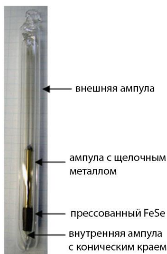
Рис. 52. Двойная ампула из кварцевого стекла для получения кристаллов Me_{0.8}Fe_2Se_2 (Me - K или Cs) [411].
