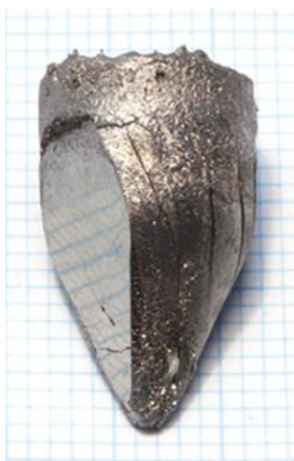
Рис. 50. Кристалл \text{FeTe}_{0.7}\text{Se}_{0.3} выращенный методом оптической зонной плавки. Левая сколотая поверхность имеет направление 001. Размер клетки - 1 мм. [312].
