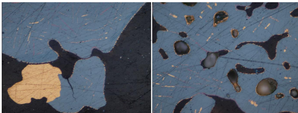
Рис. 200а, б. Оптические фотографии золотых ламелей в \text{Cu}_2\text{S} , выращенных в равновесии с золотом. Некоторые ламели имеют не золотой, а красный цвет. Увеличение 20х (а) и 50х (б).
