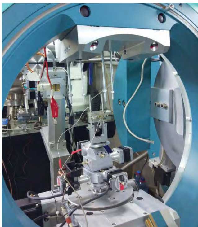
Станция рентгеновской кристаллографии и физического материаловедения «КИСИ-Курчатов» с модулем для исследования рентгеноакустических взаимодействий
