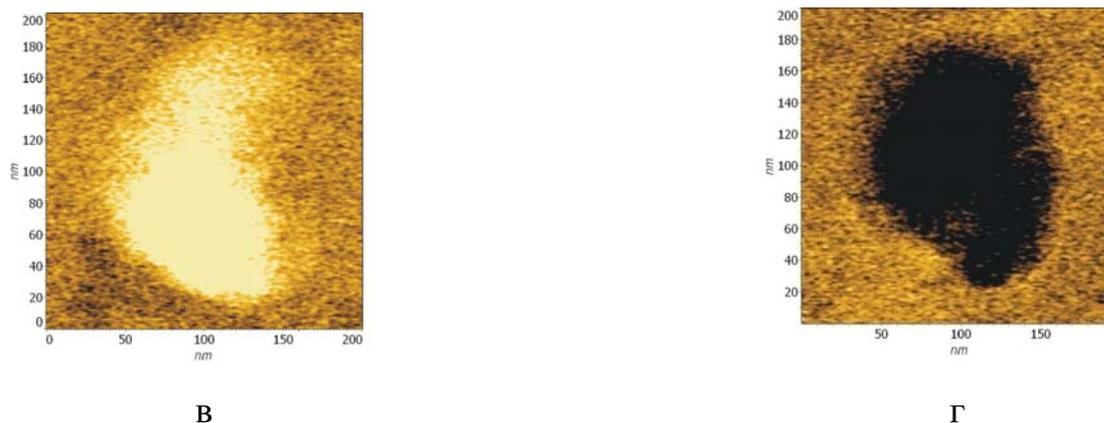
Рис.14. Переключение нанокристаллов. а – топографическое АСМ-изображение. МПО-изображения: б –исходное, в –после подачи напряжения  $+10В$ , г –после подачи напряжения  $-10В$ .
