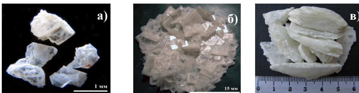
Рис. 4. Кристаллы \text{Li}_2\text{TiGeO}_5 (а – V = 0 В, R = 1 град/час; б – V = 0.5 В, R = 0.05 град/час, Pt-стержень – анод; в – V = 0.8 В, R = 0.05 град/час, Pt-стержень – анод).
