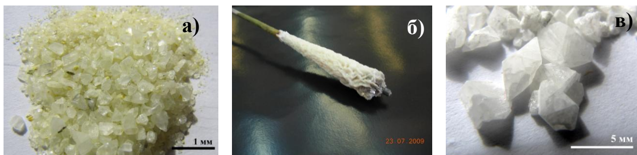
Рис. 6. Кристаллы \text{Li}_{0.49}\text{La}_{0.52}\text{MoO}_{4.03} , полученные в объеме расплава при V = 0 В (а); \text{Li}_2\text{MoO}_4 на Pt-стержне-катоде при V = 0.8 В (б); \text{Li}_{0.55}\text{La}_{0.47}\text{MoO}_{3.98} в объеме расплава при V = 0.8 В, Pt-стержень – катод (в).
