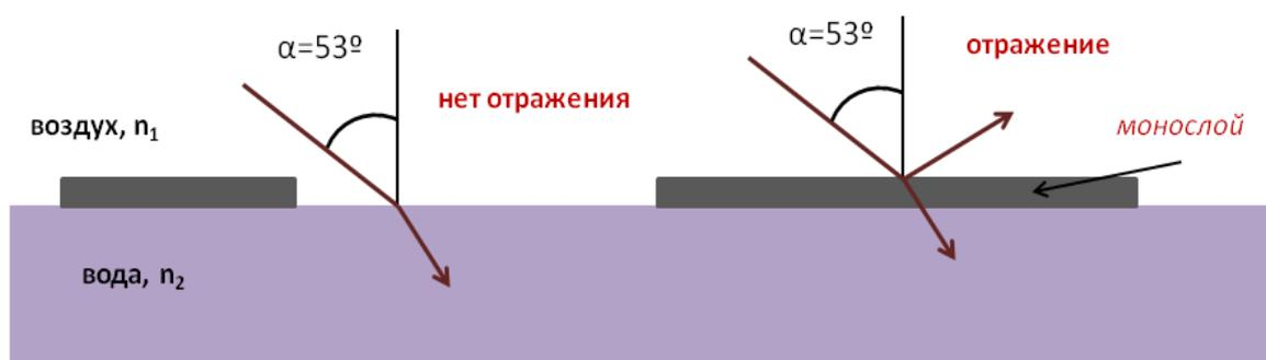
**Рис. 2.1.** Схема получения изображения от монослоя на поверхности жидкой субфазы методом Брюстеровской микроскопии.
